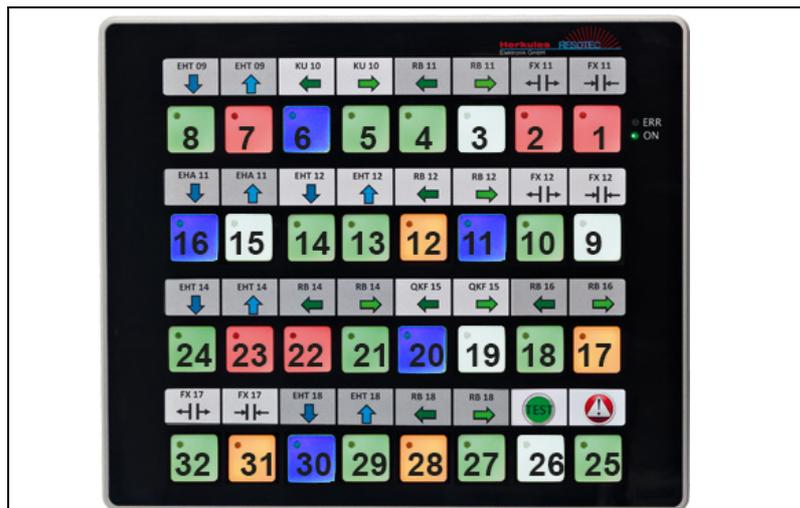
Abb. 6.39: Bedienmodul OM 2032.
